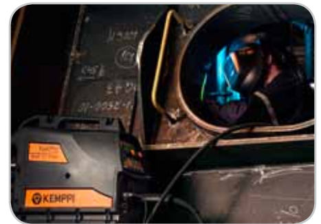
Опции Wise и Match предлагают специализированные решения программного обеспечения для сварки. Система FastMig X 450 в стандартной конфигурации включает WiseRoot+ и WiseFusion.
