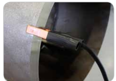
Кабель потенциального считывания измеряет фактическое напряжение дуги в ходе сварки. Это позволяет процессу WiseRoot+ оптимизировать сварочные характеристики, что гарантирует перенос присадочного материала с минимальным разбрызгиванием и стабильность сварочной дуги.
