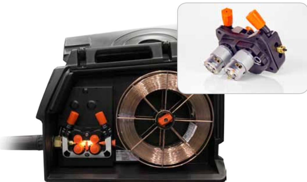
Проволокоподающий механизм GT04 включает сдвоенные синхронизированные двигатели.
